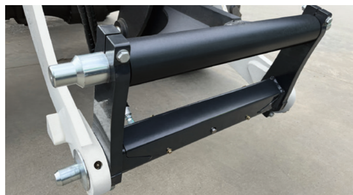
Quicktach-koppling (installerad som standard)
