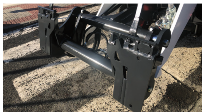
Adapter för Quick-Tach™ till Bob-Tach™ (krävs för alla redskap utom skopor och pallgafflar)
